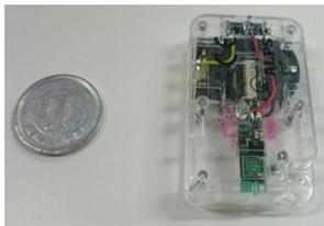
Fig. 2: IoT Smart Module センサネットワークモジュール開発キット
