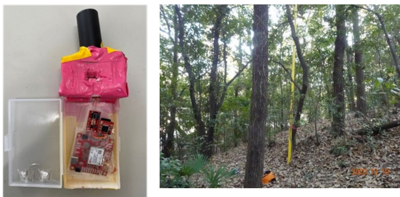
写真 1 (a) F9P センサー (左)、(b) 中心地測定の様子 (右)
