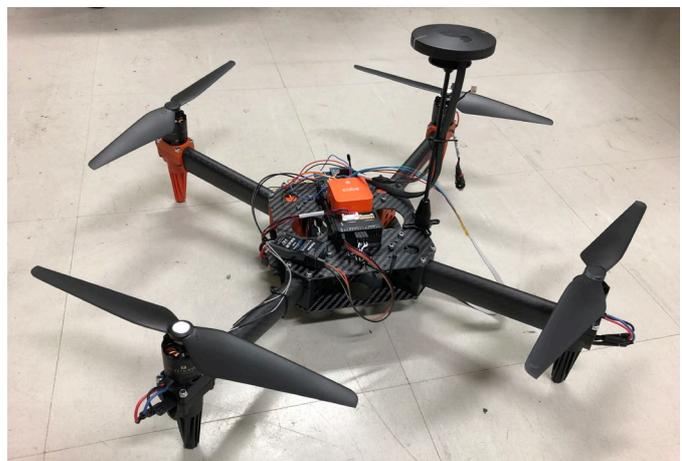
図3：pixhawk および ardupilot を用いた自作ドローン。
