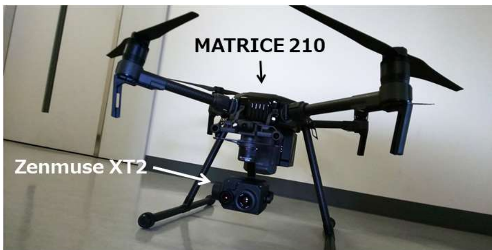
図4 本研究の調査用機器（ドローン：MATRICE210、熱赤外カメラ：Zenmuse XT2）
